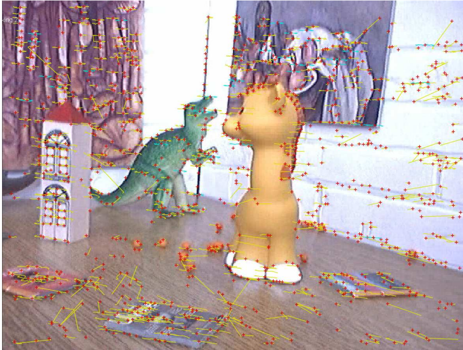
FIG. 9.21 – Appariement automatique de points d'intérêts avec Boujou.
