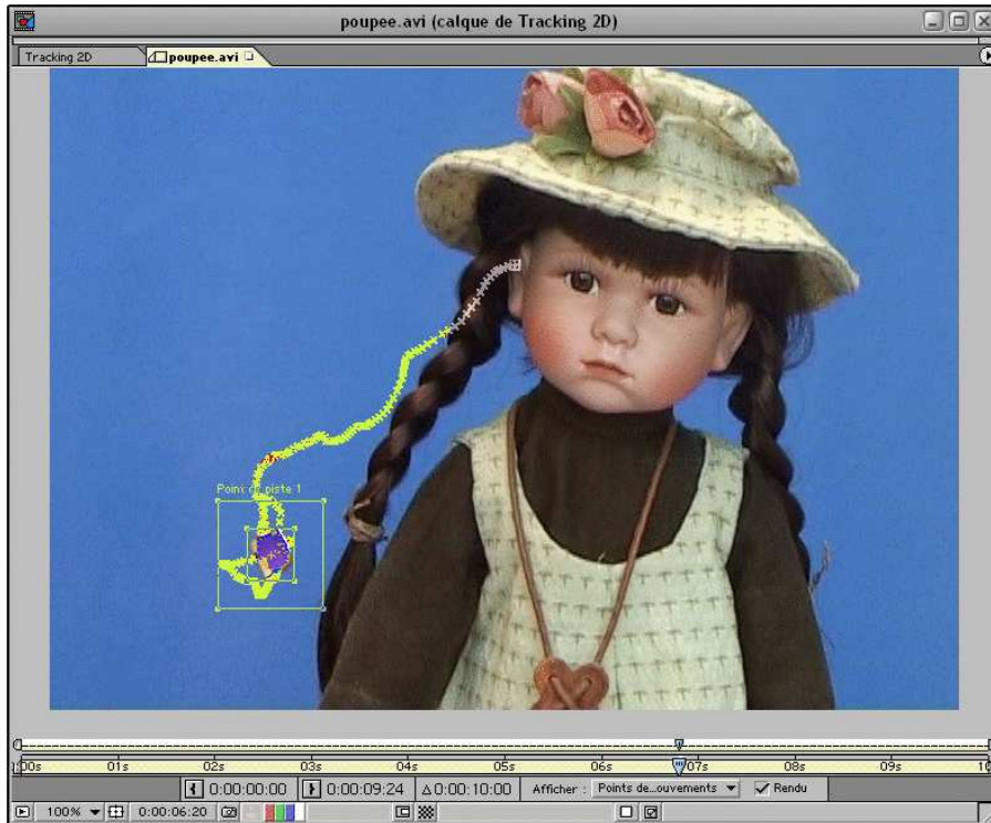
FIG. 9.34 – La trajectoire du mouvement de caméra est une suite de points 2D.
