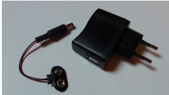
FIGURE I-17 Un adaptateur de pile 9 V avec fiche cylindrique (à gauche) et un bloc d'alimentation secteur à sortie USB (à droite).
