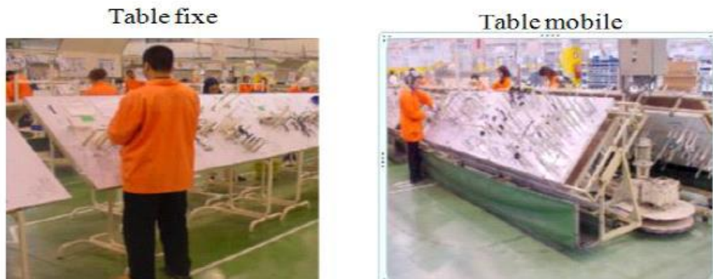
FIGURE 17: MONTAGE INDIVIDUEL ET MONTAGE EN CHAÎNE
