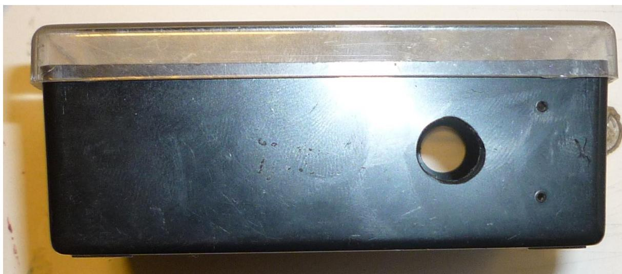
Le côté gauche avec le passage du câble d'alimentation et les trous pour le bloquer.
