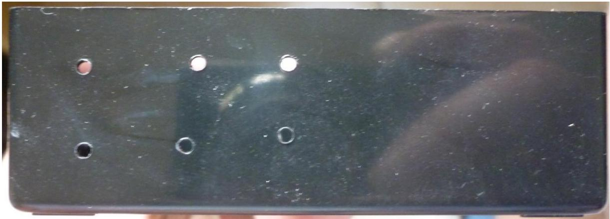
Le dessous avec deux trous pour le passage des vis supportant le circuit
