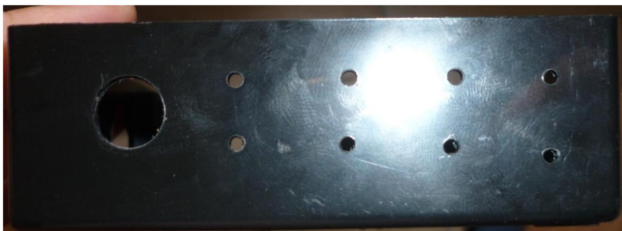
L'arrière avec également quelques trous de blocage du câble d'alimentation
