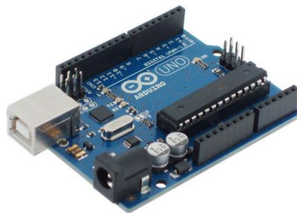
FIGURE 2.1 – *Photo d'une Arduino Uno.*
