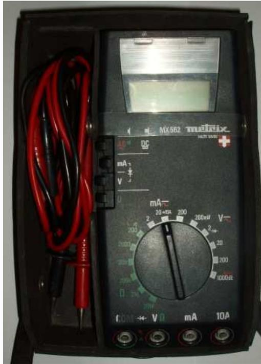
2000 points, non true RMS (pas de mesure de la valeur efficace vraie, mais uniquement de la valeur moyenne avec un coefficient pour afficher la valeur efficace d'une sinusoïde parfaite. Si la sinusoïde est déformée (sortie d'un onduleur de secours), la mesure affichée sera affectée d'une erreur)
