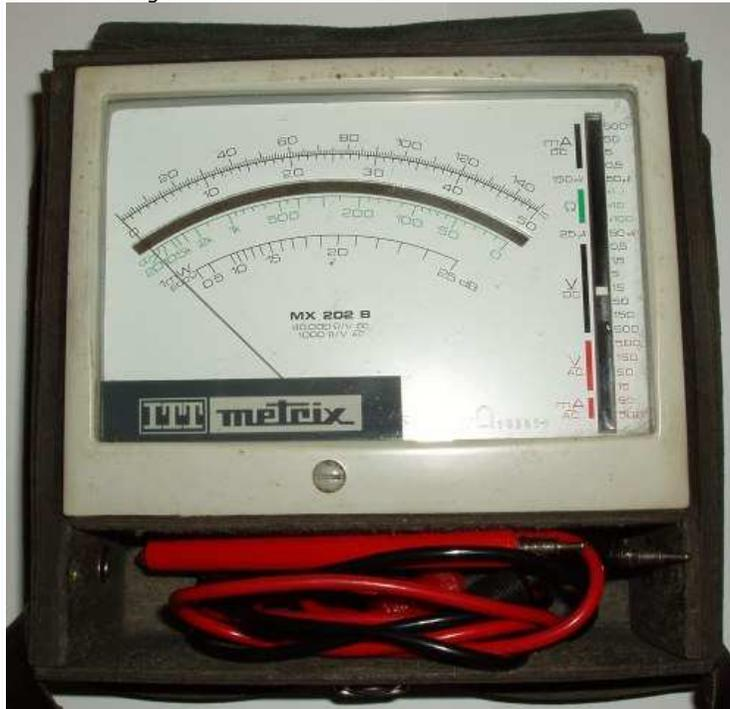
La pile pour la fonction ohmmètre contient du mercure et n'est plus disponible à la vente. Metrix vend un adaptateur. Je me passe de la fonction ohmmètre ! Les cordons de mesure ne sont pas sécurisés (pas de fiche banane de sécurité).
