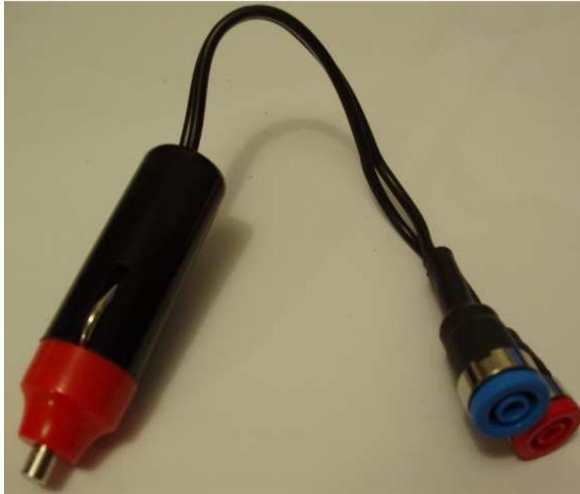
Il s'agit simplement d'une prise allume-cigare male avec deux fiches bananes femelles de sécurité pour pouvoir mesurer la tension d'alimentation, donc de la tension batterie, en roulant sans ouvrir le capot et sans tirer des fils de mesure.
