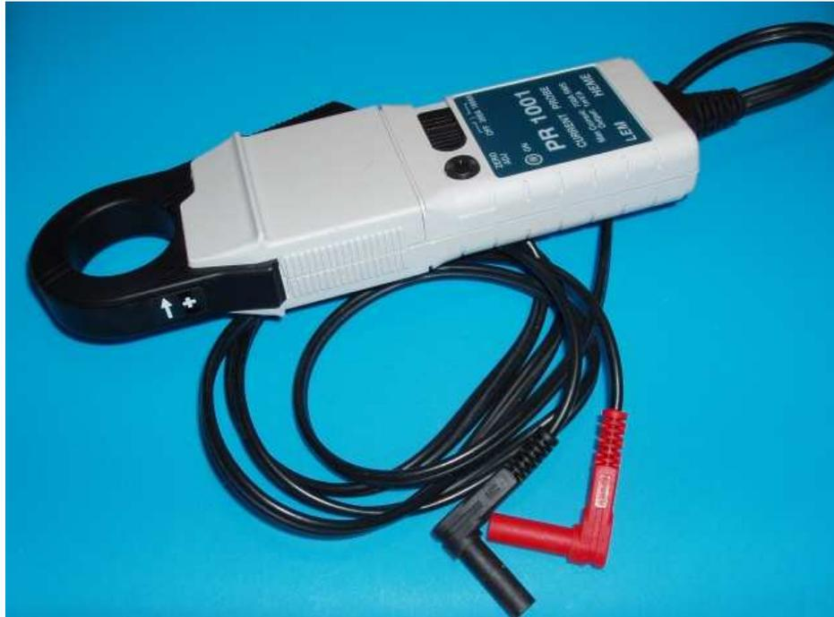
Cette pince de mesure de courant couvre les besoins de mesure des alternateurs et des démarreurs automobiles. Une pince équivalente, de calibre 20A couvre le besoin de mesure des différents équipements d'une voiture.
