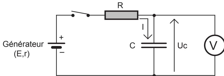
Dans ce schéma,  $R = 1 \text{ M}\Omega$  et  $C = 5 \mu\text{F}$ .
