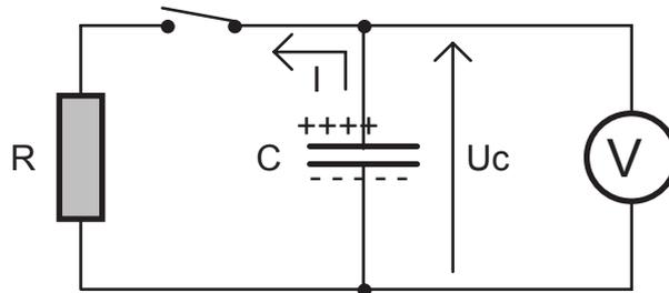
Dans ce schéma,  $R = 1 \text{ M}\Omega$  et  $C = 5 \mu\text{F}$ .
