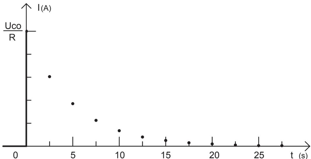
A  $t = 0$ , l'intensité du courant passe immédiatement de 0 à  $U_{C0}/R$  (pointe de courant). Puis le courant décroît exponentiellement. Son intensité est quasiment nulle au bout d'un temps  $t = 5 \times R \times C$  et elle n'évolue plus : le condensateur a perdu toute son énergie; celle-ci s'est transformée en chaleur dans la résistance R (effet Joule).
