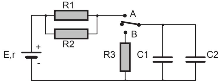
**Commutateur sur la position A** : on charge 2 condensateurs identiques, associés en parallèle, à travers un dipôle constitué de deux résistances égales en parallèle.
