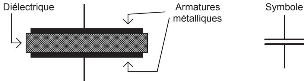
Deux plaques d'aluminium séparées par de l'air constituent un condensateur.
