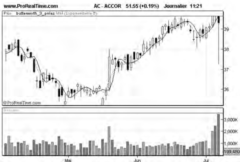
Figure 218 : Comparaison d'un filtre à 3 pôles avec une Moyenne mobile exponentielle ; : Filtre Butterworth à 3 pôles (longueur = 5) ----- : Moyenne Mobile exponentielle (longueur = 5)
