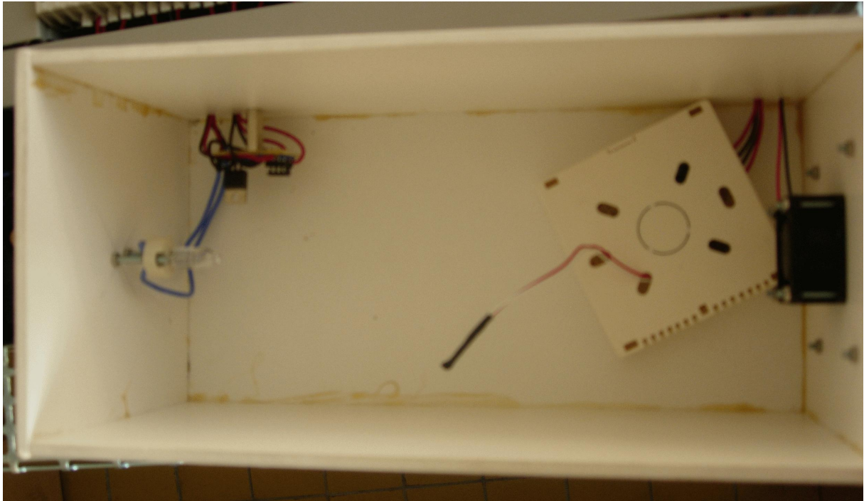
Figure 2.2 : boîte « température ». Lampe chauffante, capteur de température, ventilateur
