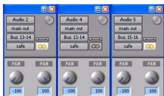
Fenêtres Output avec couplage (gauche), sans couplage (milieu), avec couplage inversé à l'avant (droite)
