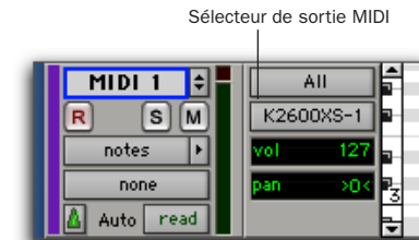
Sélecteur de sortie MIDI Sélecteur de sortie MIDI de la piste MIDI (fenêtre Edit)
