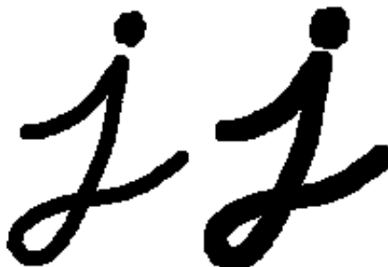
Illustration 8: Avant/Après étape d'érosion
