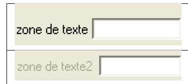
Figure 8.2 : Exemple de zone de texte ou Label associée à une zone de saisie. La seconde image montre une zone de texte dans l'état DISABLED .
